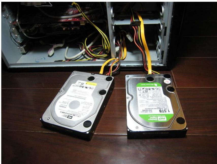
請先將用來分割硬碟的 PC 上面所有的硬碟都拔除,只連接要分割磁區的新硬碟和原本 NAS 上的硬碟(上圖右邊是新的 1.5TB,左邊是原廠的 500GB 硬碟)
